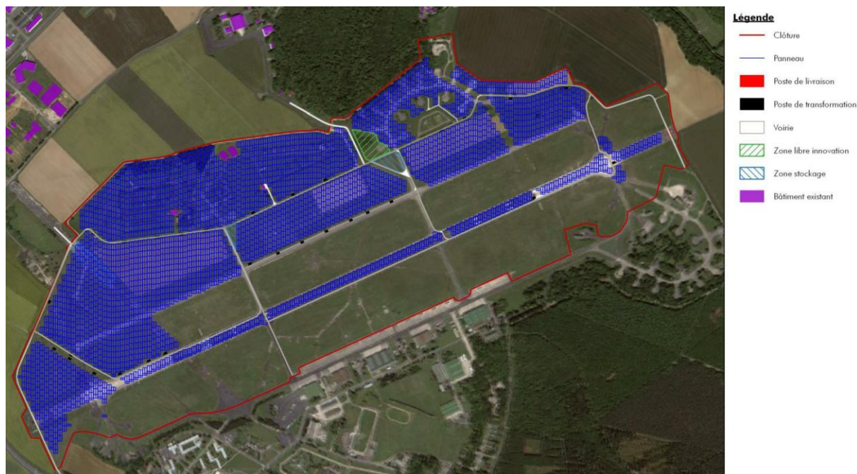
Figure 8 – Version finale du plan d'implantation du projet photovoltaïque (source : Photosol, Réalisation : ARTIFEX 2021)
