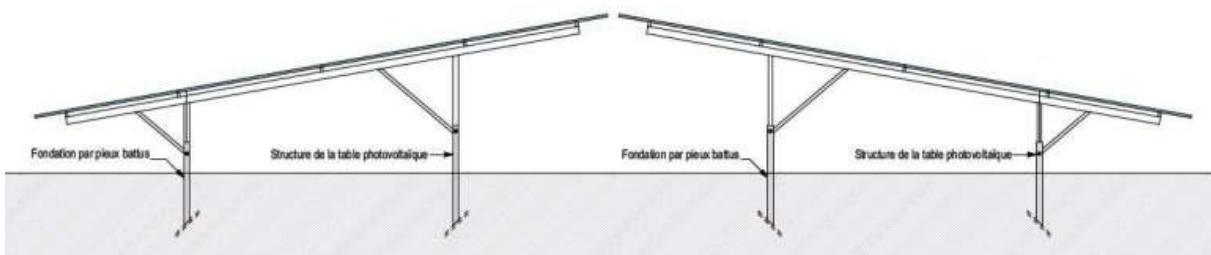
Figure 15 - Vue en coupe d'une double table photovoltaïque avec pieux battus (source : PHOTOSOL)
