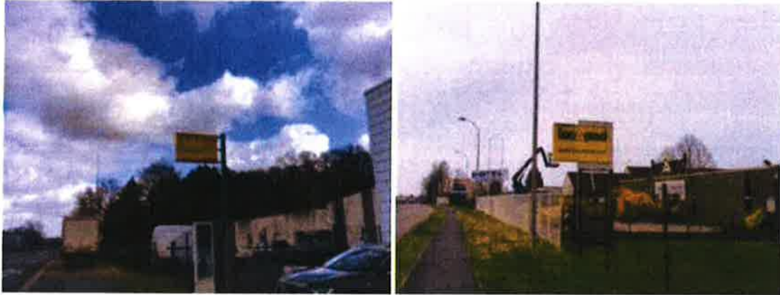
Enseignes scellées au sol ou installées directement sur le sol ne respectant pas la règle dite « H/2 », qui impose une implantation de ces enseignes à au moins la moitié de leur hauteur d'une limite séparative de propriété, mars 2021, Creil.
