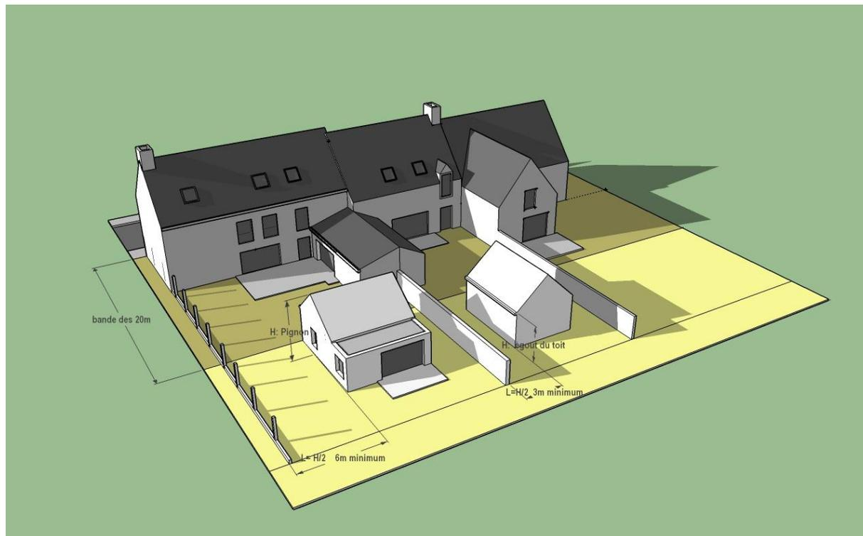
Schéma n° 1 : Implantation au-delà de la bande des 20 mètres
