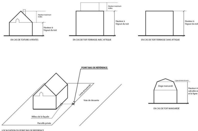
**Schéma 1 : Calculs de la hauteur maximale des constructions.**
